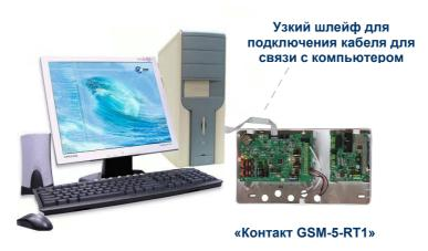
Рис.1.1. Гіример подключения охранного прибора («Контакт GSM-5-RT1») к компьютеру.
