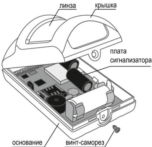
**Рис.1** Конструкция сигнализатора
