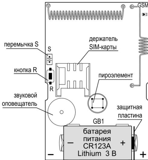
**Рис.2** Плата сигнализатора
