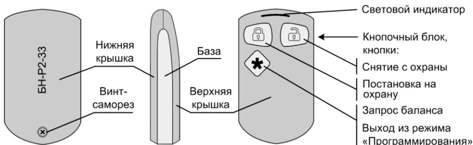
**Рис.3** Конструкция брелока. Общий вид
