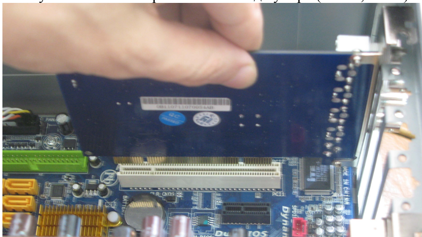
Рис. 2 Установка платы ТЕ-104С в PCI-слот
